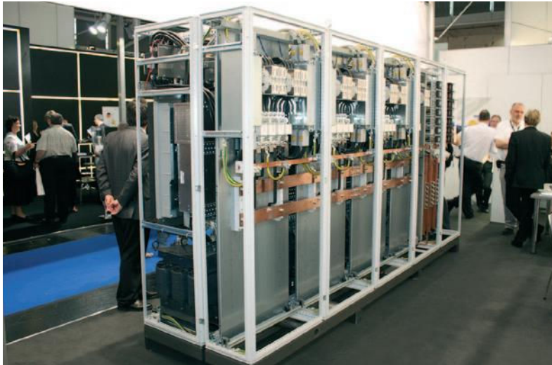
Aufgeschraubt: Dieser in München ausstellte Zentralwechselrichter lässt tief blicken. Allerdings sind die wirklich sensiblen Details unsichtbar: die Leistungselektronik im Innern.
